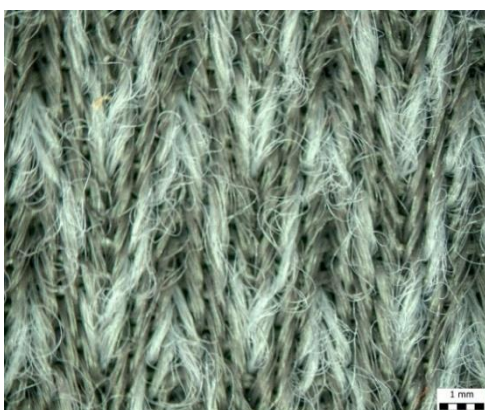
Vzorek 9 1.vrstva: pletenina 80% polyester, 20%polyamid 2.vrstva: rouno 100% polyester 3.vrstva: membrána 100% polyamid 4.vrstva:osnovní pletenina 100% polyester
