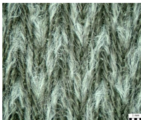
Vzorek 10 1.vrstva: pletenina 80% polyester, 20%polyamid 2.vrstva: rouno 100% polyester 3.vrstva: membrána 100% polyamid 4.vrstva: osnovní pletenina 100% polyester
