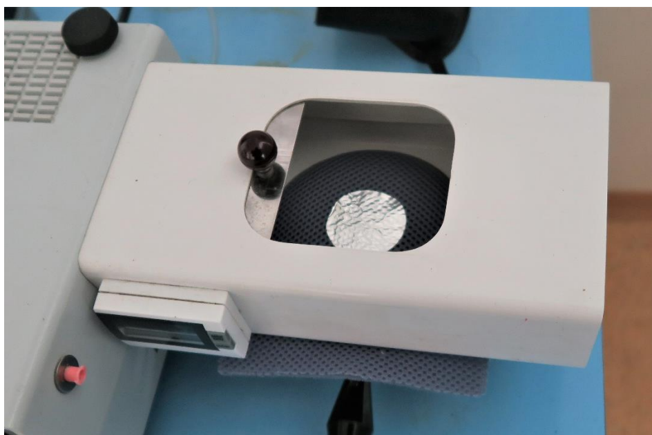
Obr. 22: Umístění měřeného vzorku se zakrytím na střed
