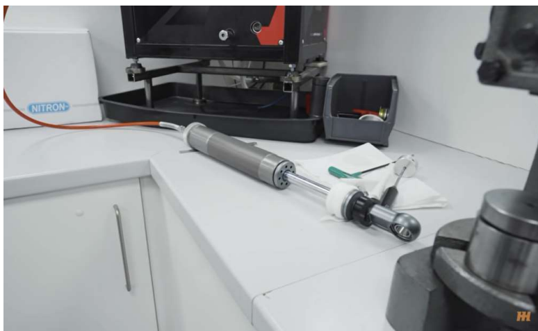
Obr. 2-11 Plnenie tlmiča značky Nitron pri výrobe [13]
