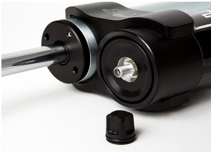
Obr. 2-9 Expanzná nádoba s autoventilom [10]
