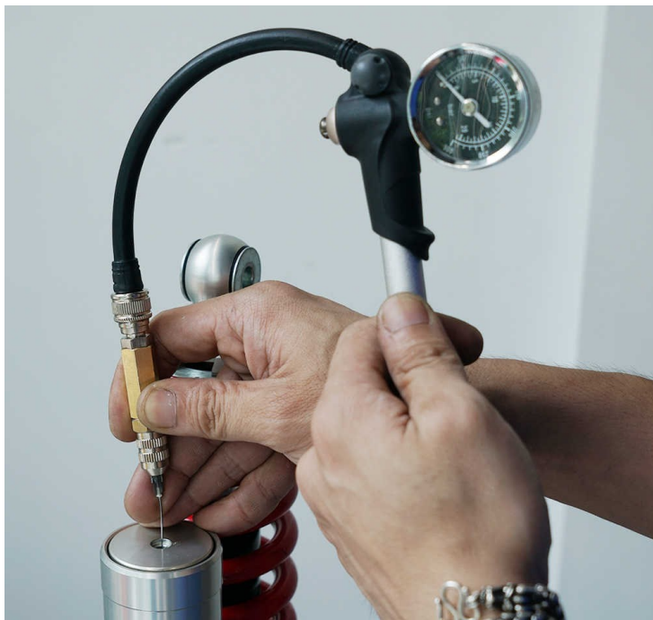
Obr. 1-1 Tlakovanie expanznej komory tlmiča pomocou ihly [1]
