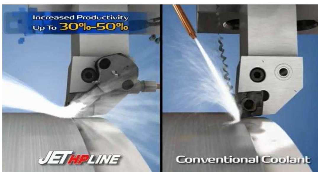
Obr. 54 Porovnání technologie JET HPC s konvenčním chlazením [28].
