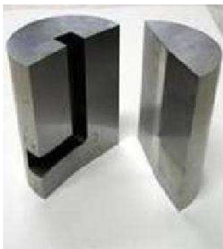
Obr. 30 Dělená zápustka se ze zalomeným kanálem [9].
