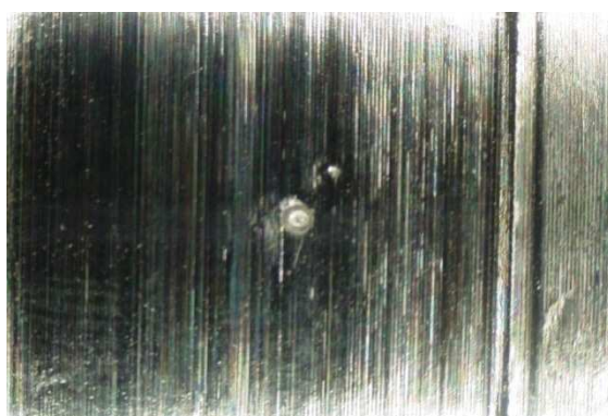
Obr. 82 Povrch obrobený řeznou rychlostí v_c = 15 \text{ [m.min}^{-1}\text{]} .
