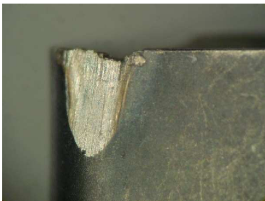
Obr. 66 Destrukce břitu Pramet 6615.
