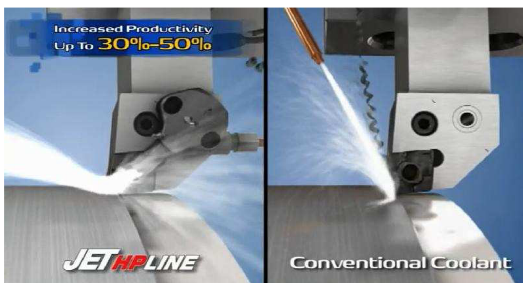
Obr. 54 Porovnání technologie JET HPC s konvenčním chlazením [28].
