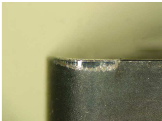
Obr. 76 Opotřebení při v_c = 15 [m.min -1 ].
