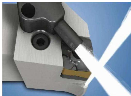
Obr. 53 Technologie chlazení čela i hřbetu nože tlakovou kapalinou JET HPC [28].
