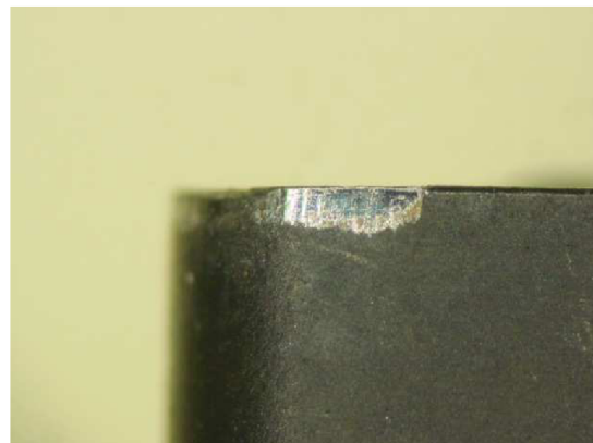
Obr. 77 Opotřebení při v_c = 25 [m.min -1 ].
