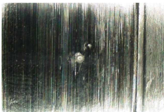
Obr. 82 Povrch obrobený řeznou rychlostí v_c = 15 \text{ [m.min}^{-1}\text{]} .
