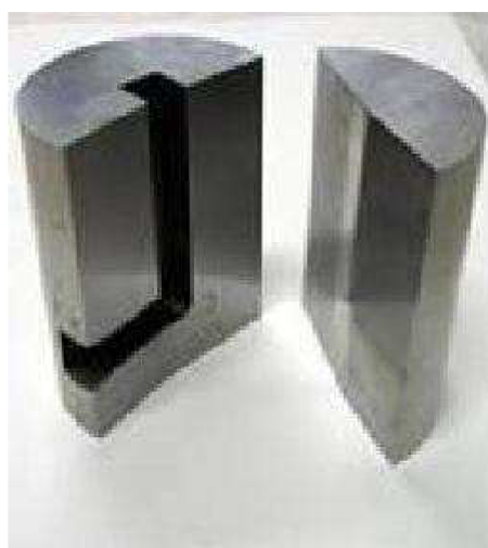
Obr. 30 Dělená zápustka se ze zalomeným kanálem [9].
