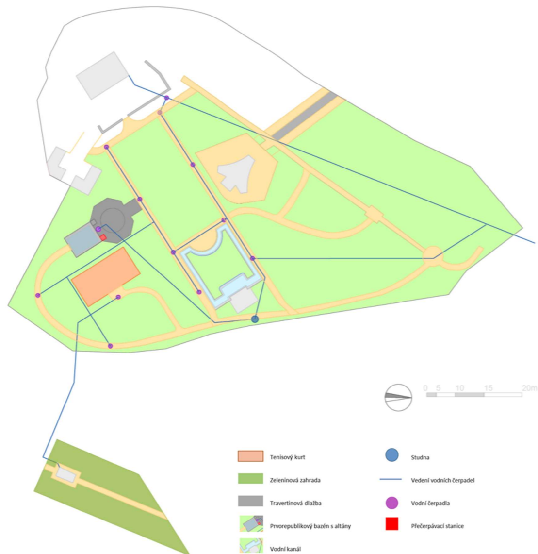
Obr. 26: Situace ukazuje překreslený plán na projekt zavodnění zámeckého parku od ateliéru Artesia.
