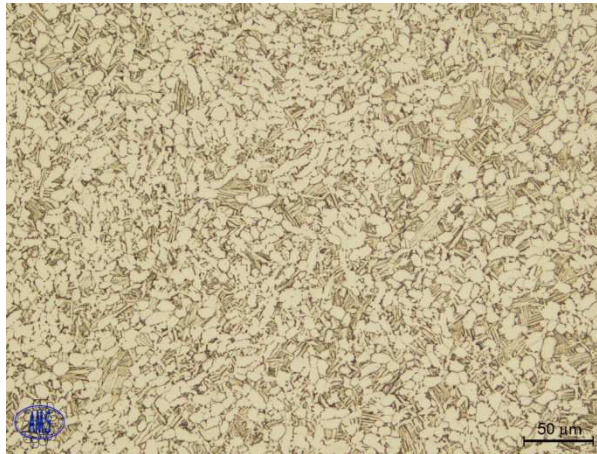
Obr 2.3.2.1 Mikrostruktura slitiny \alpha+\beta Ti: Ti6Al4V [23]
