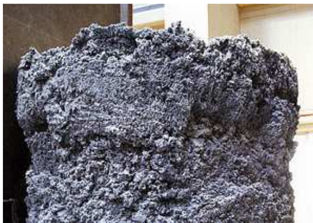
Obr 2.2.1.1 Titanová houba (výchozí materiál - rutil) [7]
