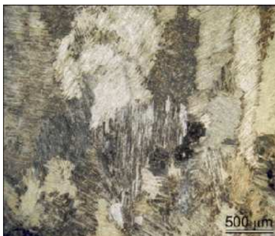
Obr 2.3.5.1 Mikrostruktura TiAl intermetalika: TiAl-2Nb [27]
