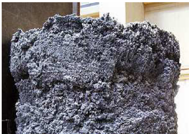
Obr 2.2.1.1 Titanová houba (výchozí materiál - rutil) [7]
