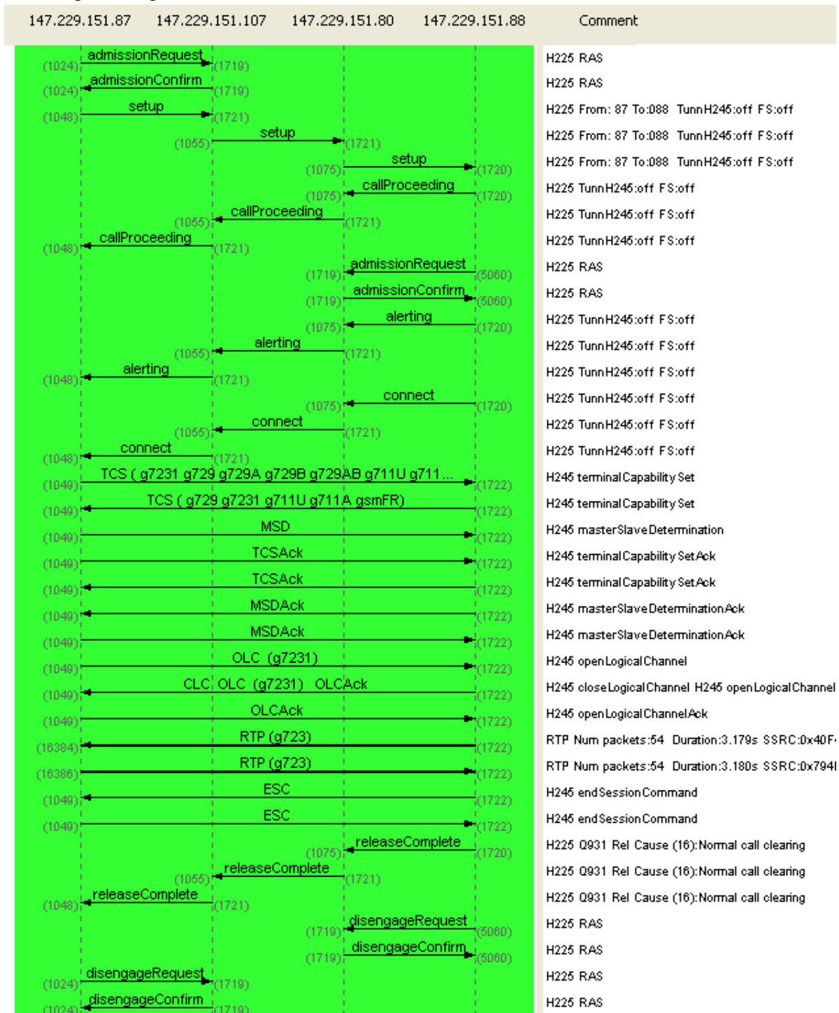
Obrázek C. 6 Propojení H.323 domén detekované pomocí programu Wireshark
