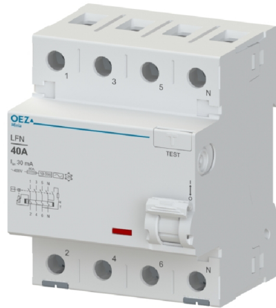
Obr. 5.5: Proudový chránič s reziduálním proudem 30 mA [13].
