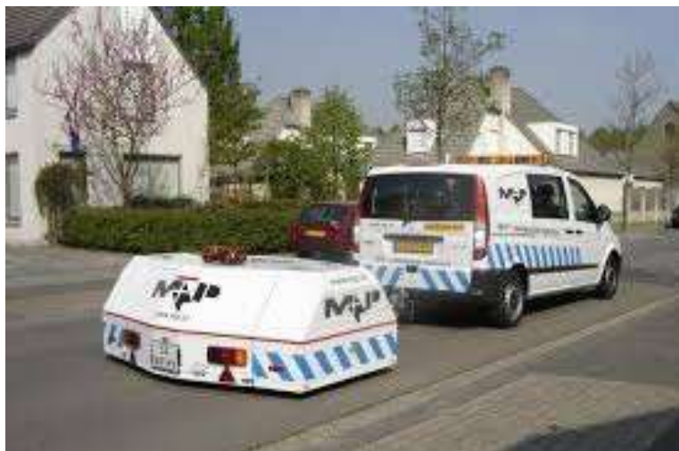
Obr. 13: Přívěs pro měření metodou CPX
