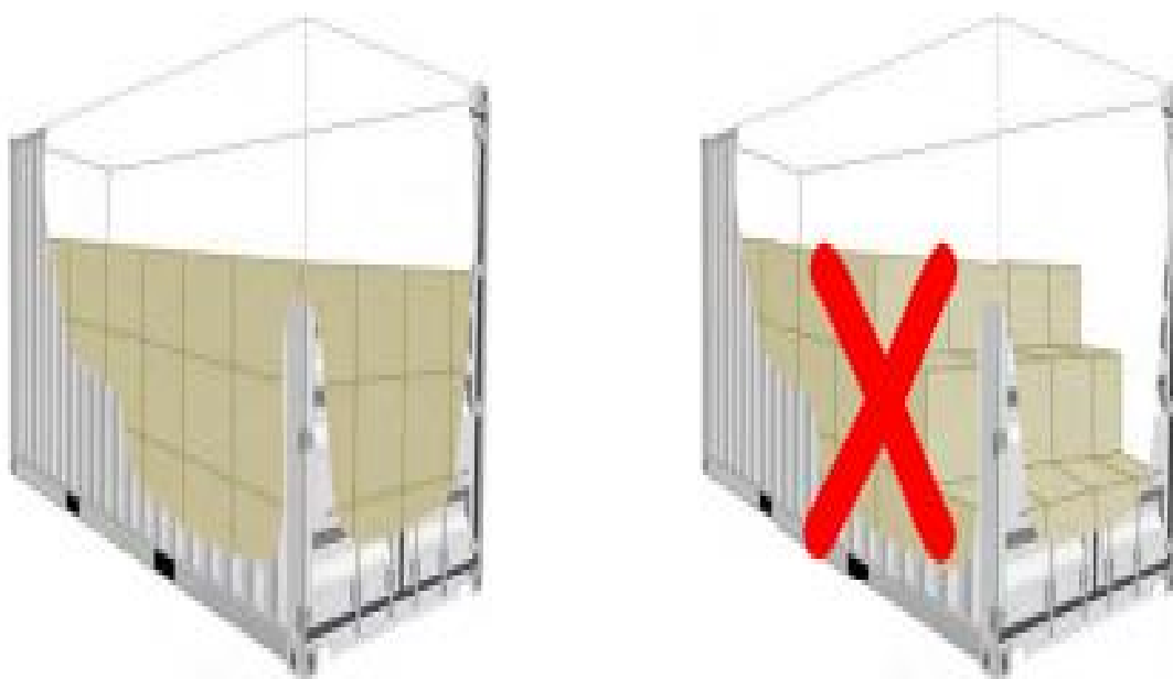
Obr. 3.4 Rovnoměrné a nerovnoměrné naložení zboží
