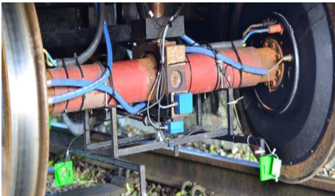
Obr. 4.2 Senzory na dvojkoli
