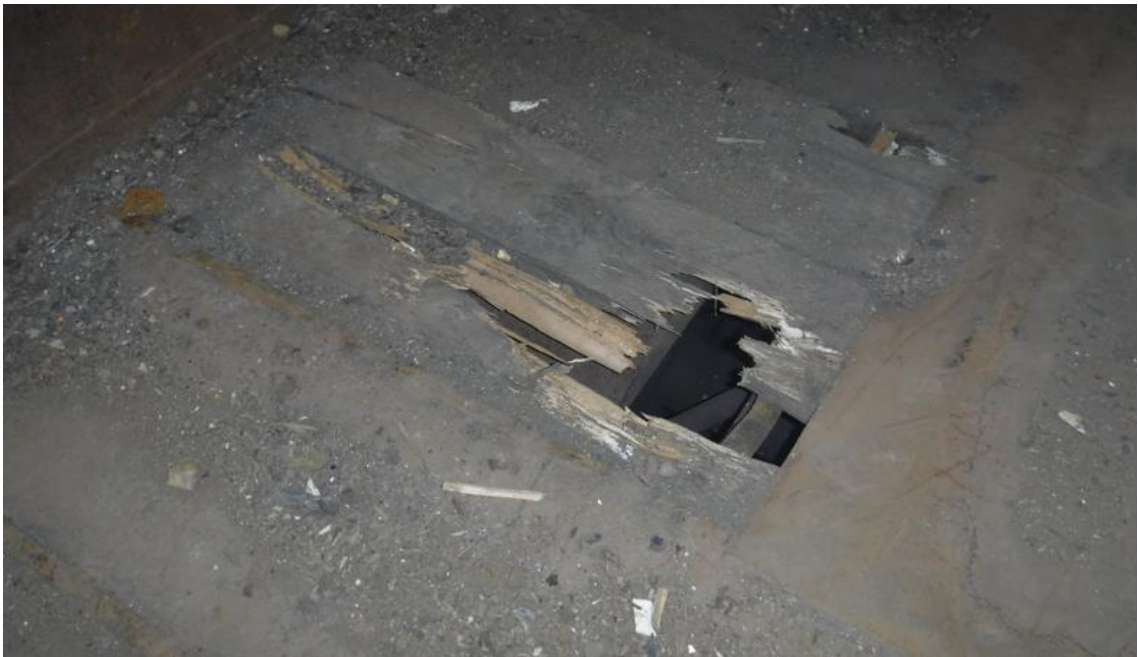
Obr. 2.6 Poškození podlahy vozu
