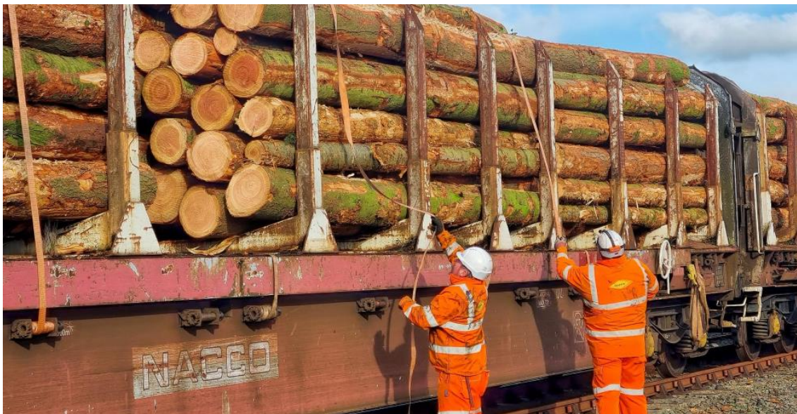
Obr. 3.5 Zajištění nákladu stahovacími popruhy
