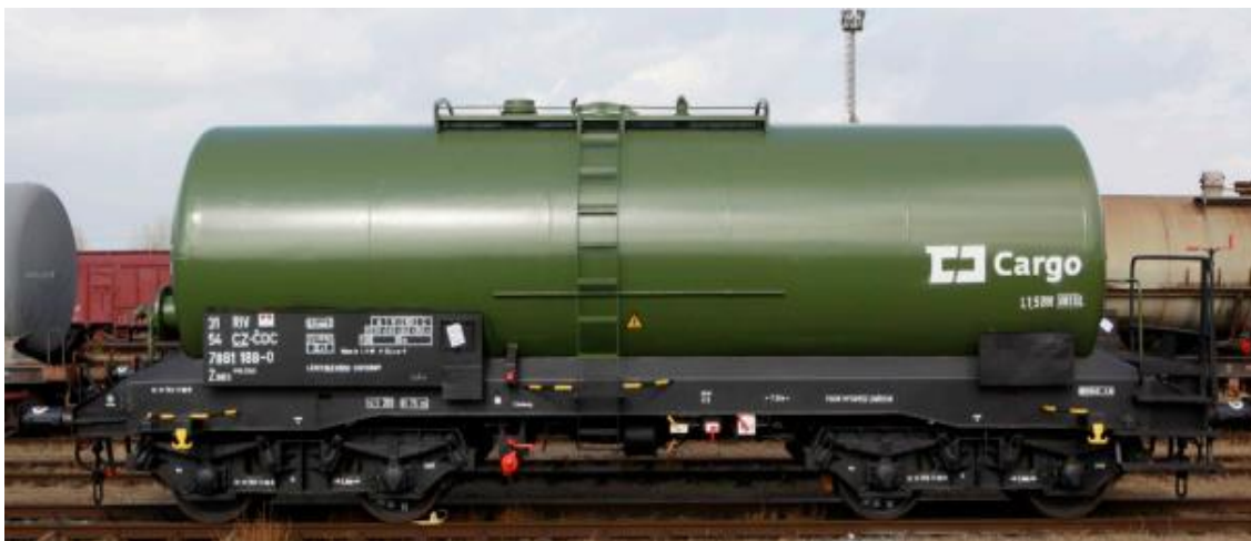
Obr. 2.3 Železniční vůz řady Zaes
