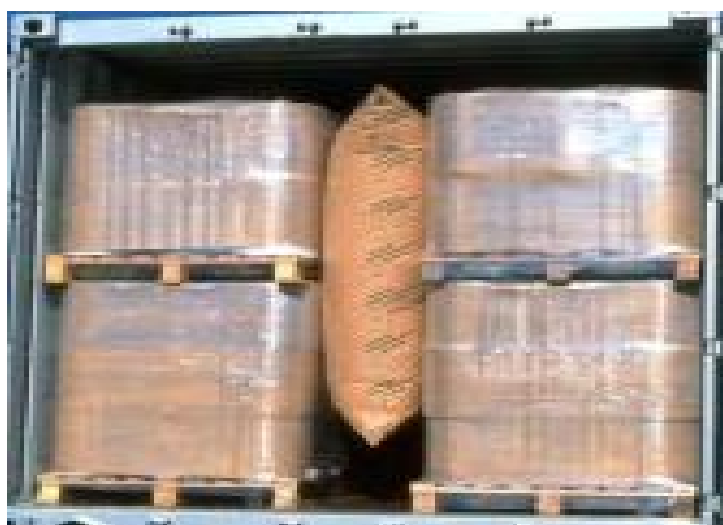
Obr. 3.10 Využití vzduchový pytlů
