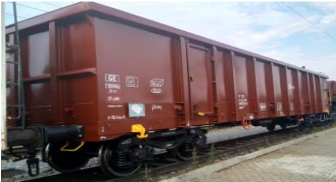
Obr. 2.2 Železniční vůz řady Eanos
