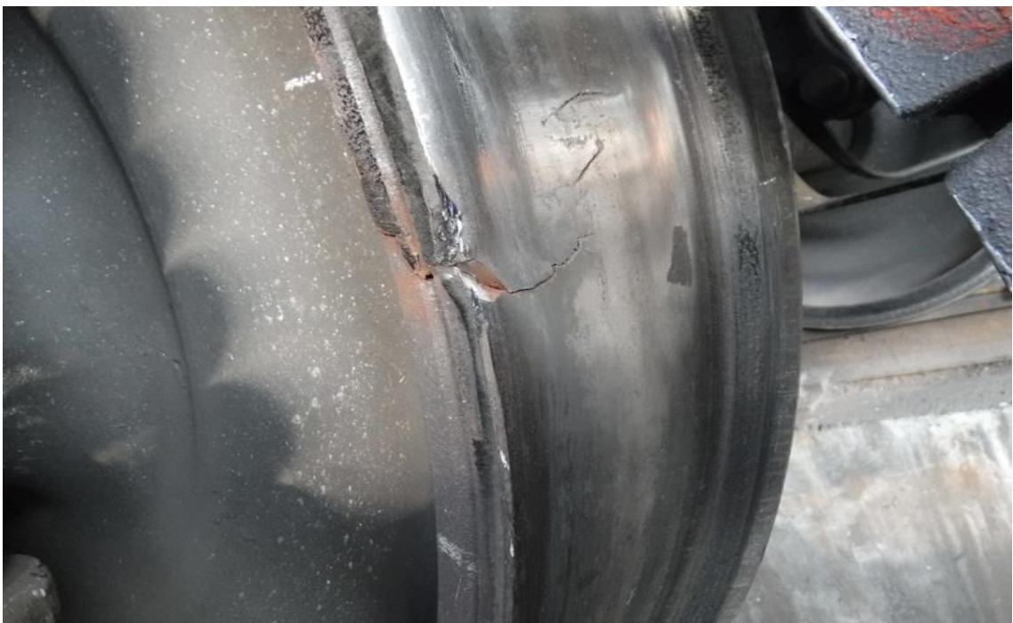
Obr. 2.7 Poškození dvojkolí vozu
