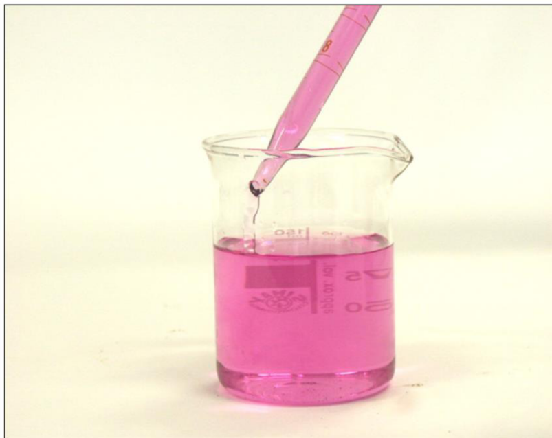
Obrázok 9: Správne vypúšťanie pipety [18]
