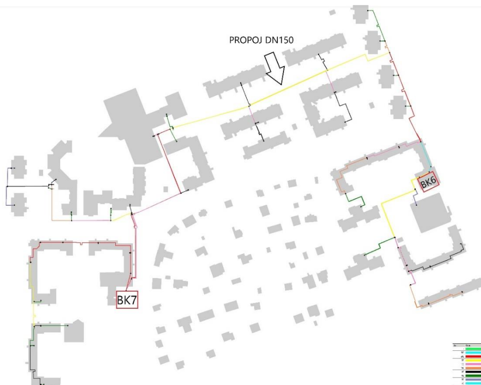
Obr. 4.1 Situace propojení kotelny BK6 s BK7
