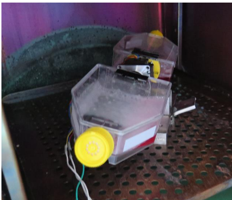
Obr. 13: Prototyp přístroje na kultivaci suspenzních buněk. Přístroj byl vytvořený v Laboratoři integrity genomu Mgr. Martinem Mistríkem, Ph.D.
