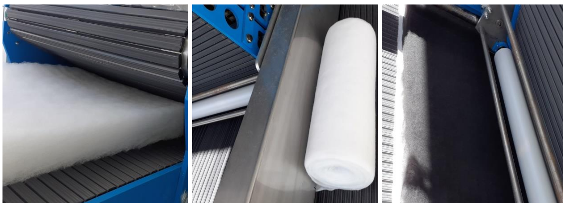
Obrázek 28: Výroba vzorku vpichované netkané textilie z bílých a černých vláken
