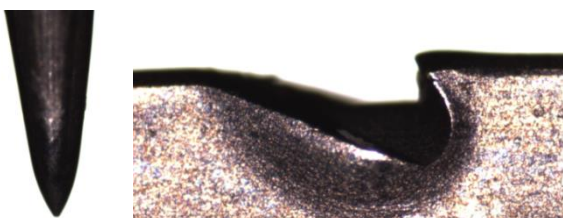
Obrázek 32: Detailní pohled na hrot a osten jehly TriStar
