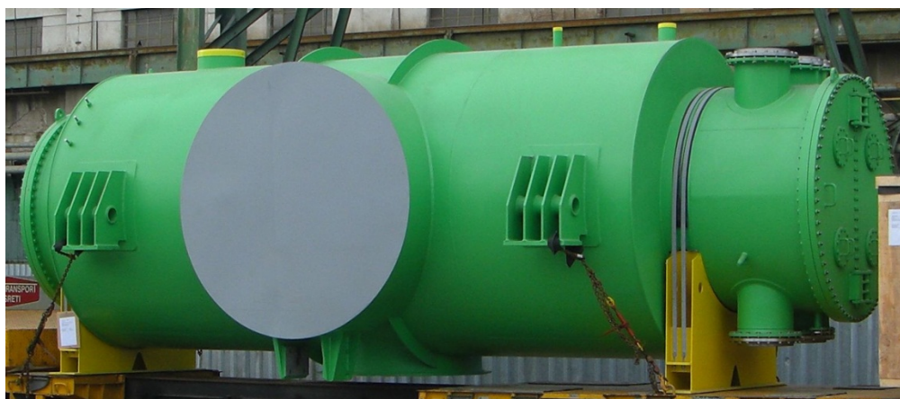
Obr. 3.1 Povrchový kondenzátor s axiálním vstupem páry [16]
