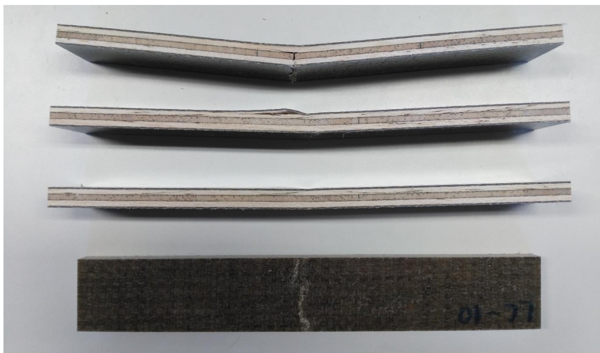
Příloha č. 5b: Vzorek LC (výztuž: len, matrice: SAP CLR reaktoplast)
