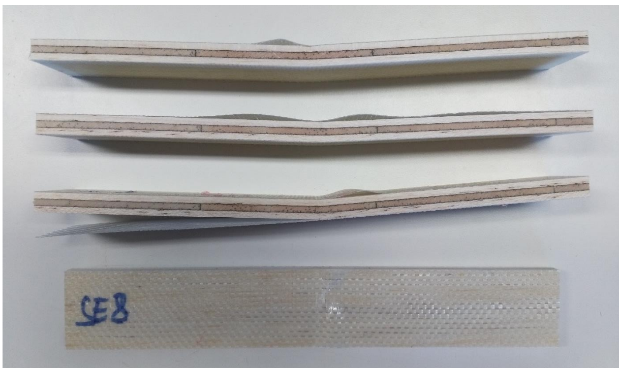
Příloha č. 5d: Vzorek SE (výztuž: sklo, matrice: Arkema Elium 188 termoplast)
