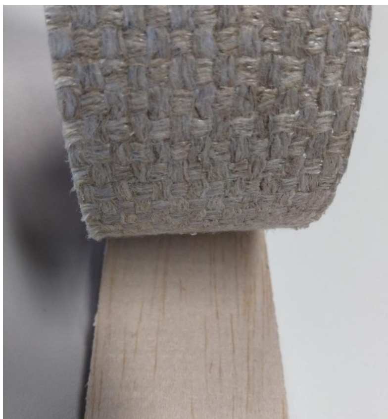
Příloha č. 6: Neprosycená vnitřní strana vnější výztuže
