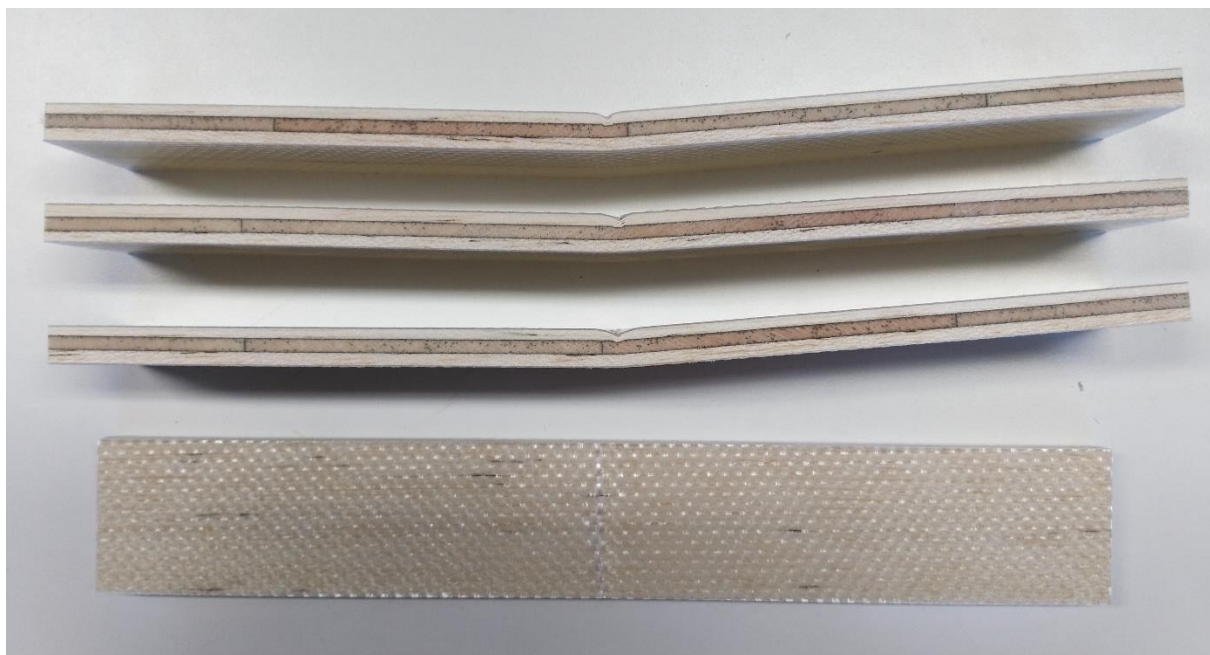
Příloha č. 5e: Vzorek SC (výztuž: sklo, matrice: SAP CLR reaktoplast)
