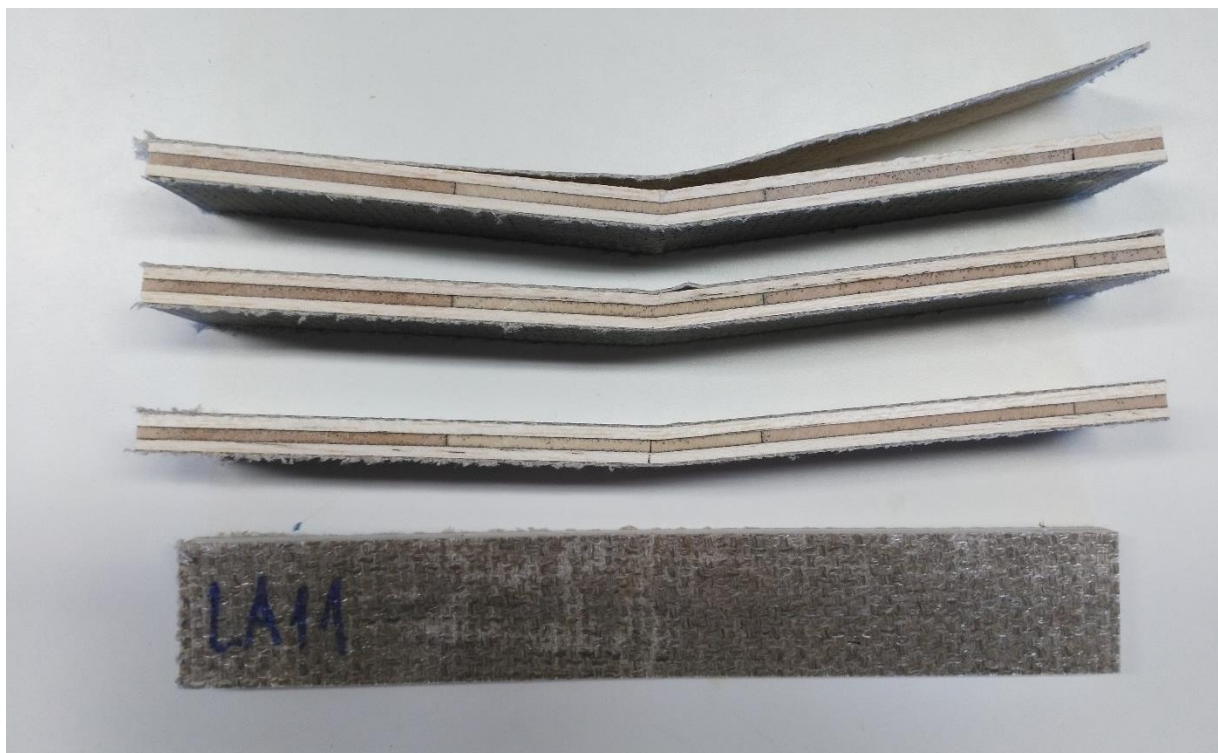
Příloha č. 5c: Vzorek LE (výztuž: len, matrice: Arkema Elium 188 termoplast)
