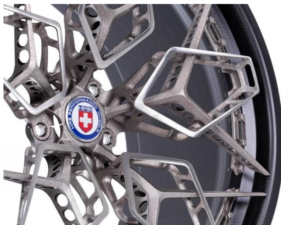
Obr. 2 Stred kola vyrábaný 3D tlačov z titánu [6]
