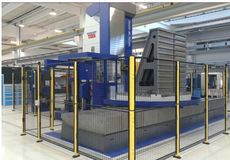
Obrázek 24- Ochranné ploty frézovacího a vyvrtávacího stroje [26]
