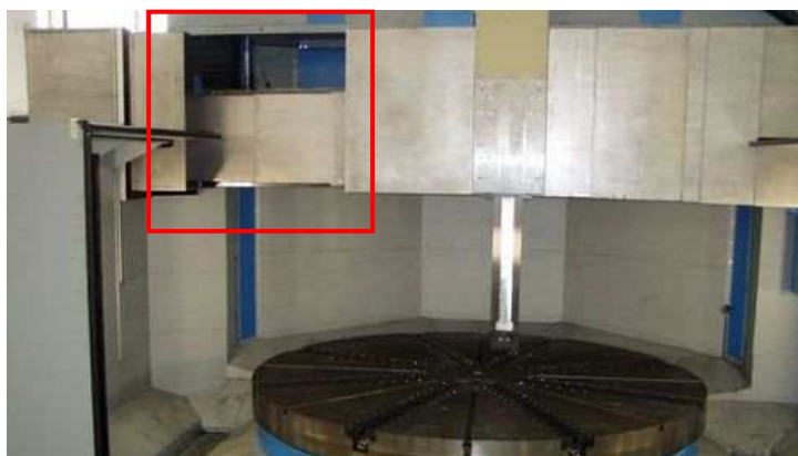
Obrázek 48 – Rozpojené teleskopické kryty stroje Powerturn 4000 [35]
