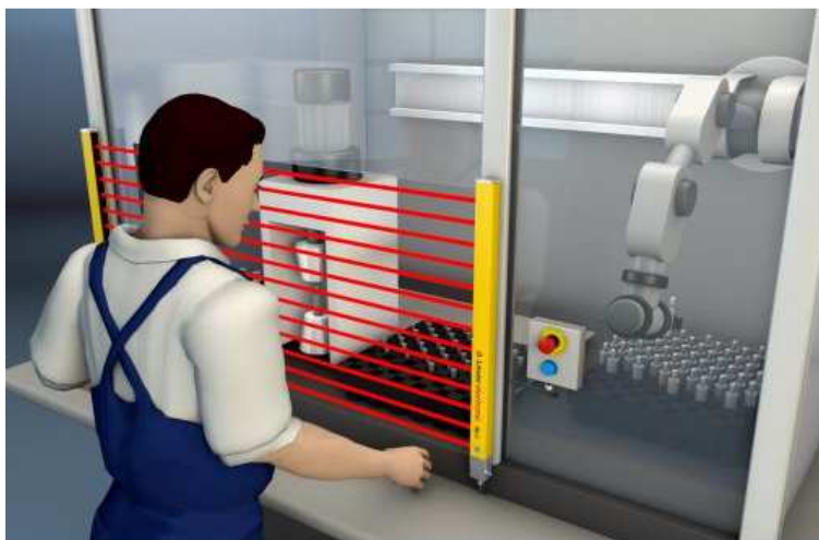
Obrázek 25- Příklad použití optické závory [20]
