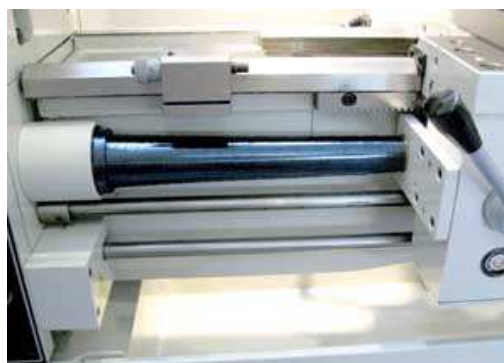
Obrázek 16- Teleskopické pružiny a příklad použití [11]
