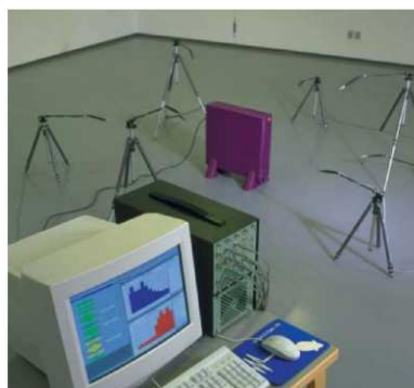
Obrázek 42 – Měřicí plochy a realizace měření akustického výkonu [7]
