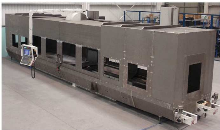
Obrázek 19- Kryt obráběcího centra sestavený z plechových dílců [21]
