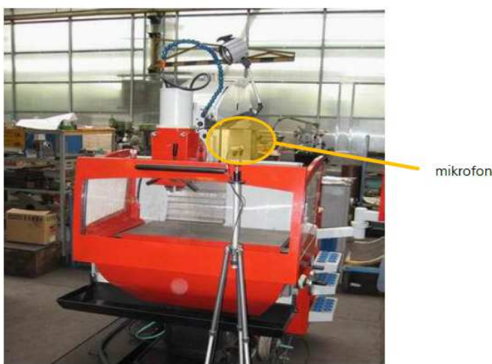
Obrázek 41 – Příklad měření emisní hladiny akustického tlaku v místě obsluhy[7]
