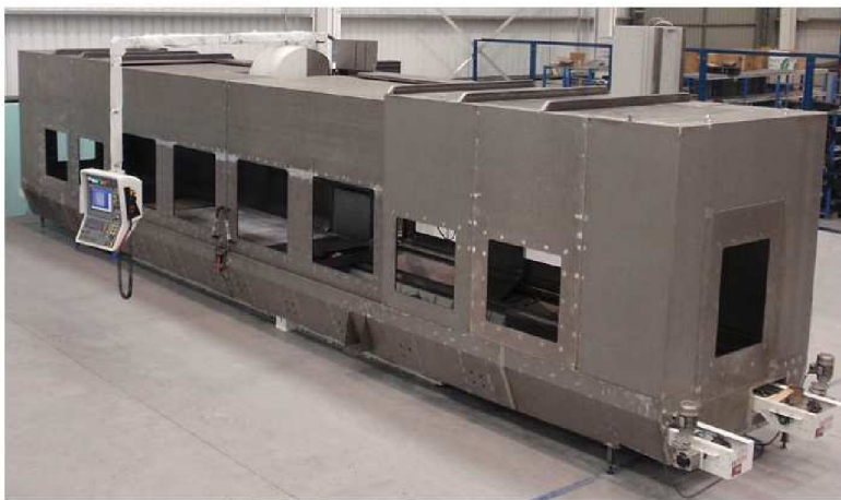
Obrázek 19- Kryt obráběcího centra sestavený z plechových dílců [21]
