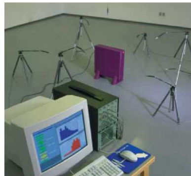
Obrázek 42 – Měřicí plochy a realizace měření akustického výkonu [7]
