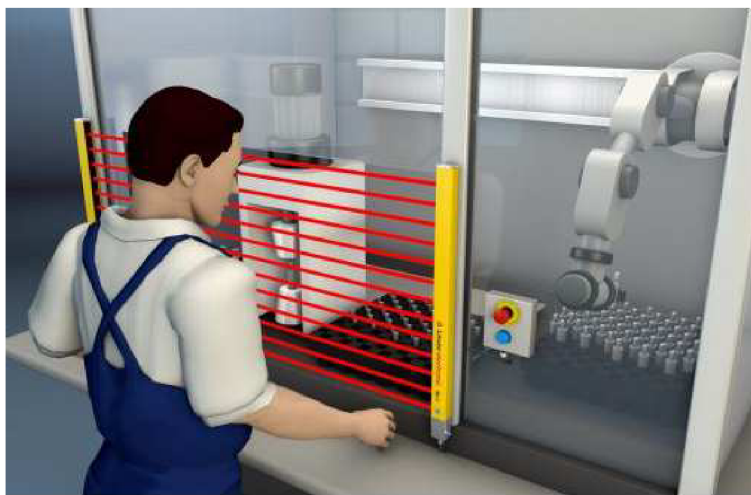
Obrázek 25- Příklad použití optické závory [20]
