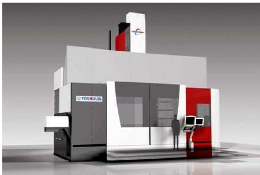
Obrázek 18- Krytování obráběcího centra Toshulin [18]
