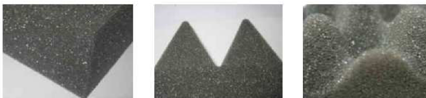
Obrázek 31 – Stupeň zvukové pohltivosti pro různé tvary PUR akustických panelů[31]
