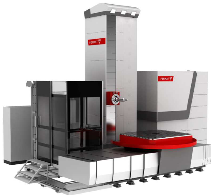
Obrázek 26 – Horizontální obráběcí centrum s kabinou operátora [27]
