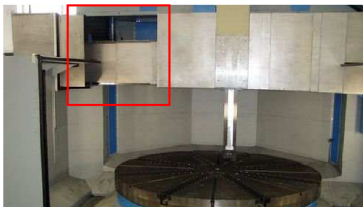
Obrázek 48 – Rozpojené teleskopické kryty stroje Powerturn 4000 [35]
