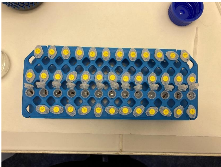
Obrázek 1. Označené mikrozkušavky s exempláři louhujícími se v chloroformu
