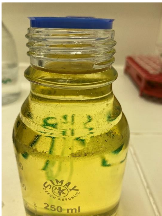
Obrázek 2. Detail použitého chloroformu zbarveného do žluta díky extrakci lipidů
