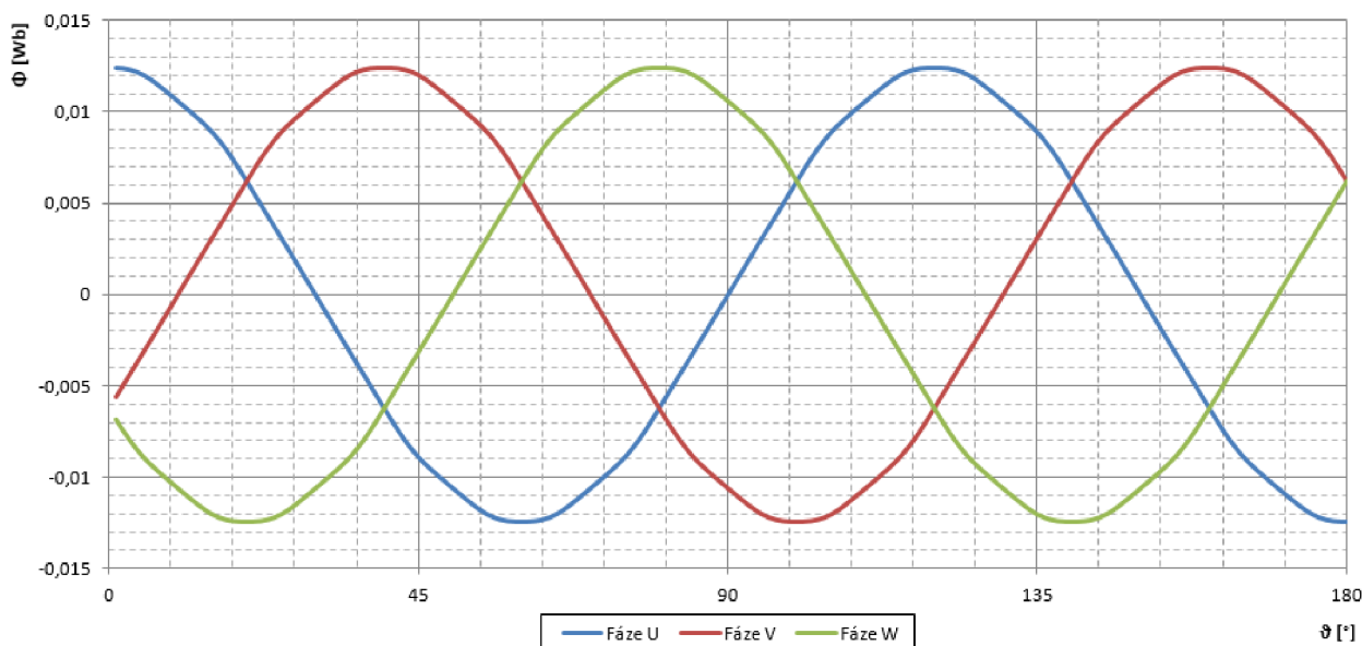
Obrázek 43: Průběhy magnetických toků lineárního modelu 9 drážek na 6 pólů
