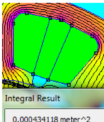
Obrázek 32: Plocha statorové drážky, výstup z programu FEMM
