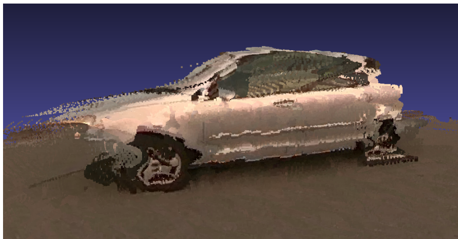
Obr. 6.3: Mračno bodů vytvořené 3D kamerou (Volkswagen)
