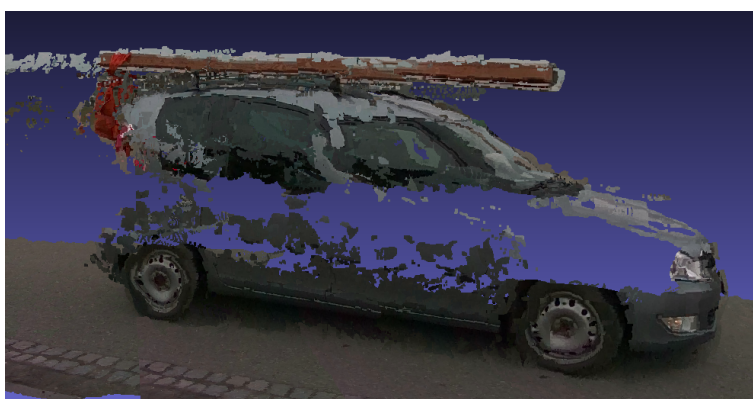
Obr. 6.2: Mračno bodů vytvořené 3D kamerou (Škoda)
