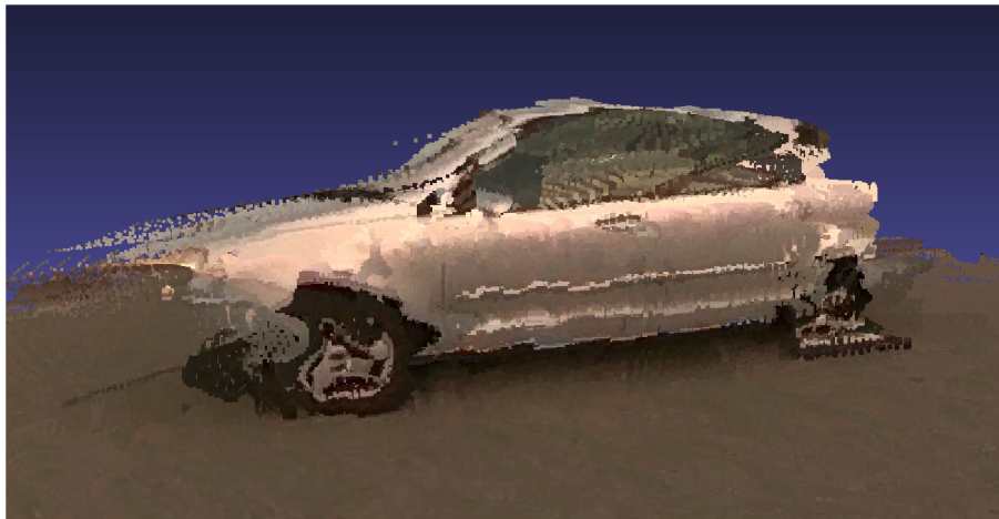
Obr. 6.3: Mračno bodů vytvořené 3D kamerou (Volkswagen)
