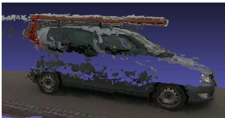
Obr. 6.2: Mračno bodů vytvořené 3D kamerou (Škoda)
