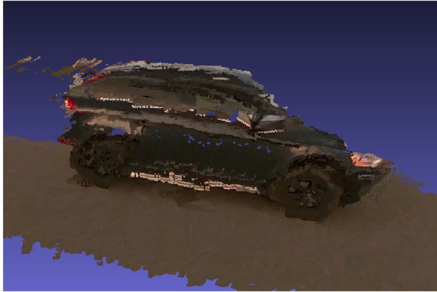
Obr. 6.4: Mračno bodů vytvořené 3D kamerou (Volvo)
