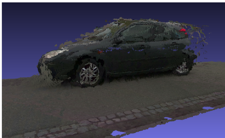
Obr. 6.1: Mračno bodů vytvořené 3D kamerou (Ford)
