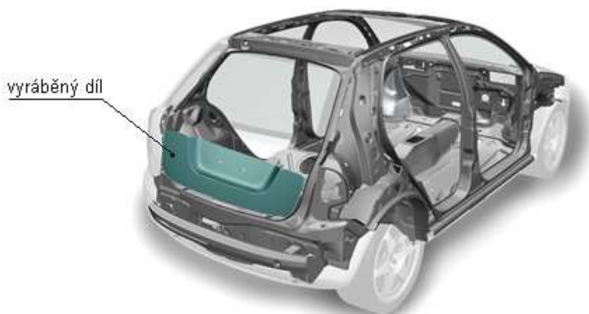
Obr. 1.1.1 Ilustrativní obrázek, umístění vyráběného výtažku v karoserii 19
