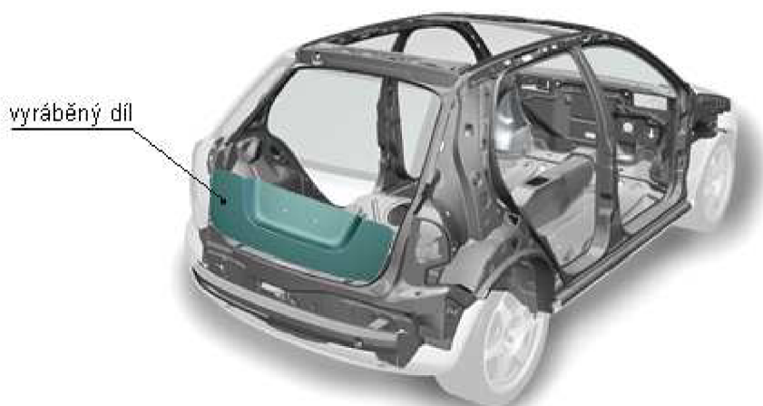
Obr. 1.1.1 Ilustrativní obrázek, umístění vyráběného výtazku v karoserii 19
