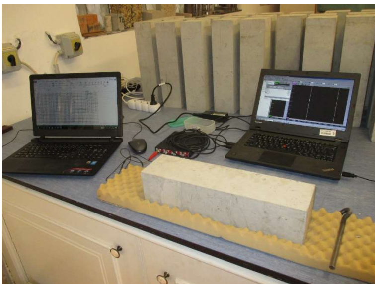
Obr. 19 Měřící sestava pro rezonanční metodu
