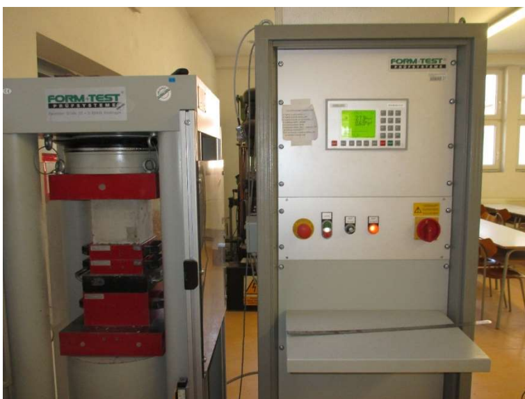
Obr. 13 Zkouška pevnosti betonu v tlaku
