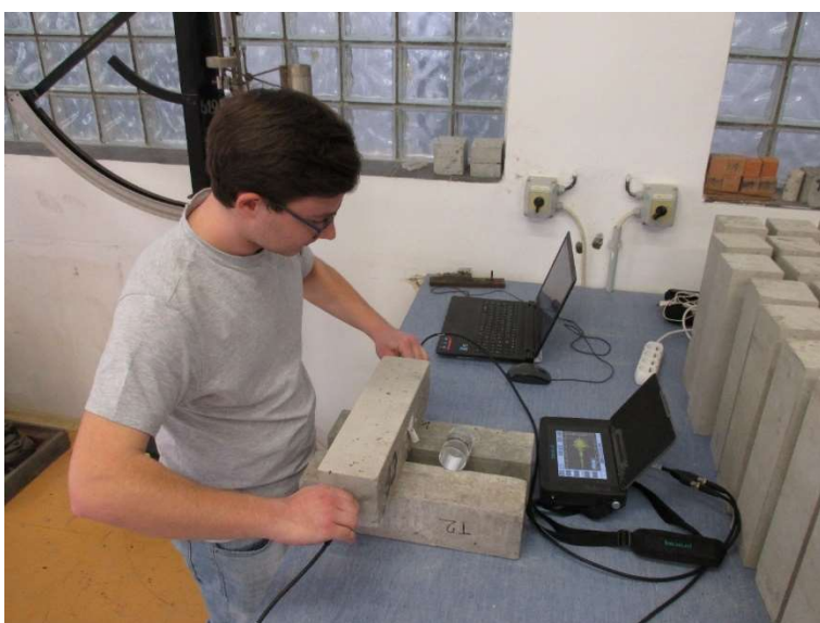
Obr. 21 Měření doby průchodu impulzu UZ vlnění vzorkem
