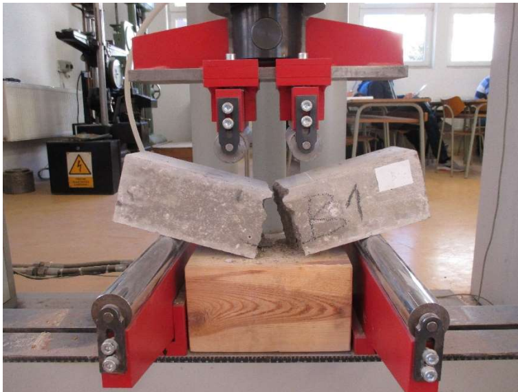
Obr. 15 Zkouška pevnosti betonu v tahu tříbodovým ohybem
