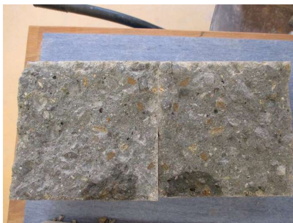
Obrázek 22 Ukázka hloubky průsaku tlakovou vodou [10] na vzorku betonu E
