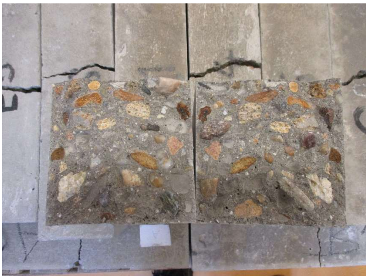
Obr. 16 Lom po zkoušce tříbodovým ohybem u vzorku betonu G
