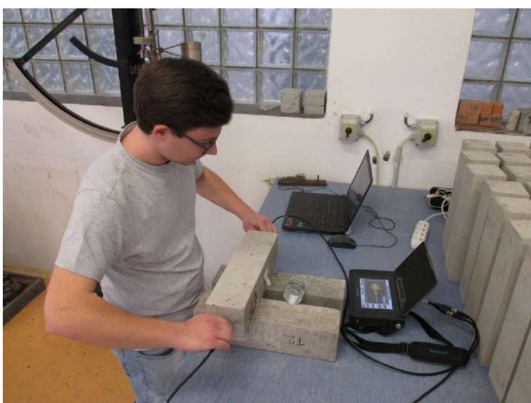
Obr. 21 Měření doby průchodu impulzu UZ vlnění vzorkem
