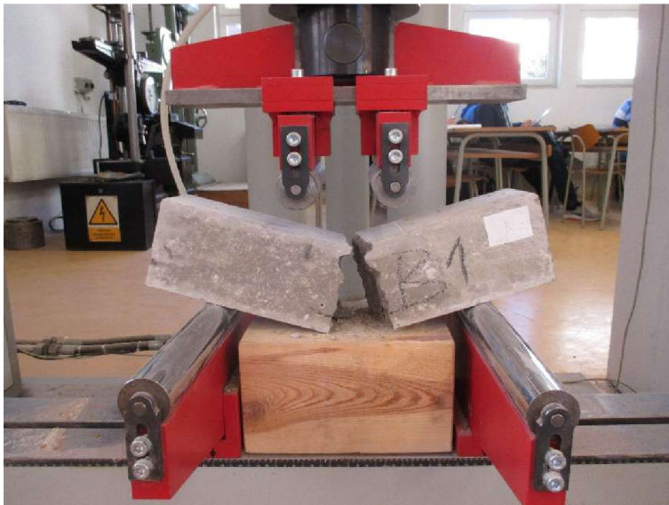
Obr. 15 Zkouška pevnosti betonu v tahu tříbodovým ohybem
