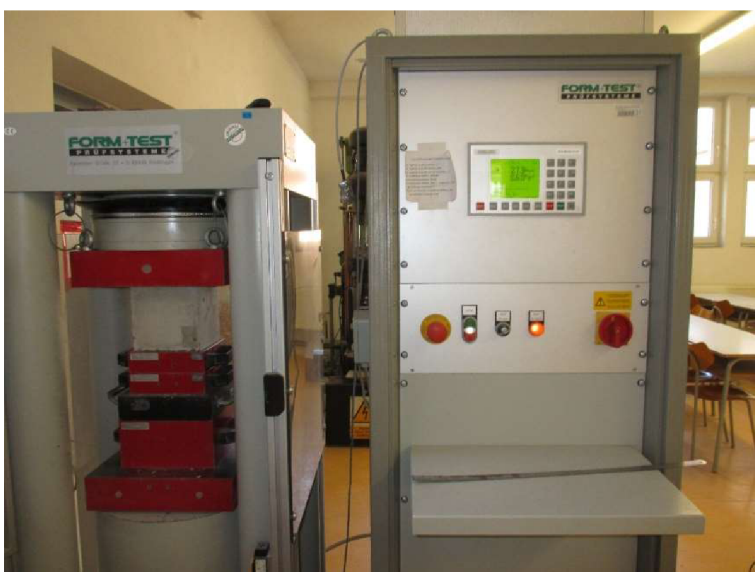
Obr. 13 Zkouška pevnosti betonu v tlaku
