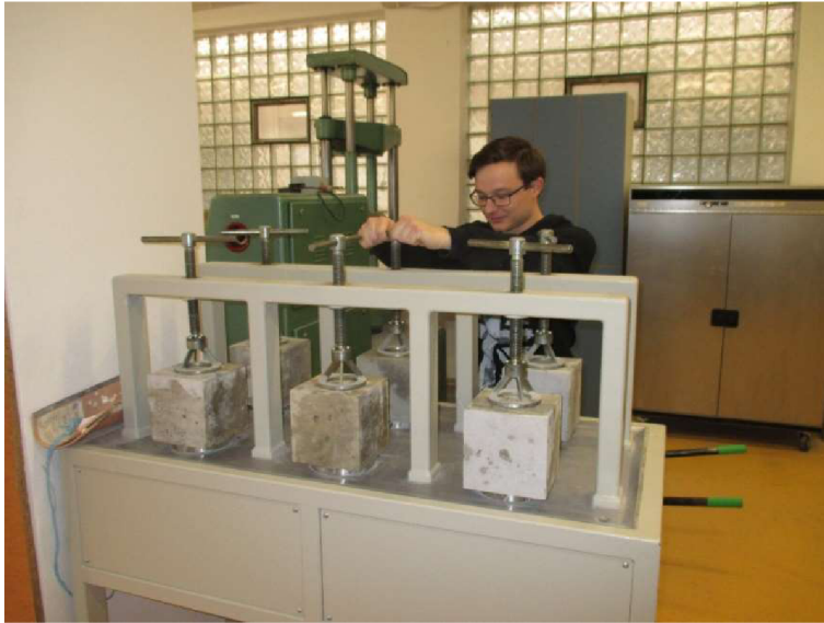
Obr.14 Usazování krychlí na stoličce pro zkoušení hloubky průsaku tlakovou vodou
