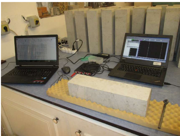
Obr. 19 Měřící sestava pro rezonanční metodu
