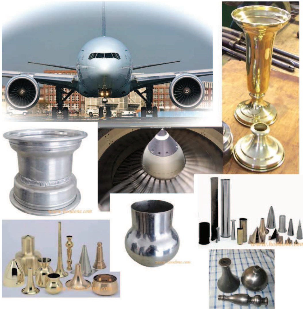
Obr. 1 Příklady tlačených dílců [30], [31]
