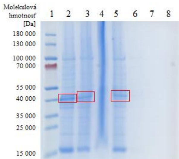
Obrázok 19: Obrázok gélu pre \alpha_2 C45. Podmienky expresie boli: hodnota absorbancie 0,5; 100 \mu M IPTG, 1000 \mu M L-arabinóza, 1x indukované. Poradie vzoriek bolo: 1 - štandard, 2 – bunky+purifikačný pufer, 3 – supernatant, 4 – pelet, 5 – prechod kolónou, 6 – premývací pufer 10 ml, 7 – premývací pufer 10 ml, 8 – elúcia. Červenou je zvýraznený proteín C45. V ľavej časti sú uvedené molekulové hmotnosti štandardu.
