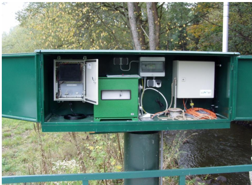
Obrázek č. 5. Digitální limnigraf – přístrojem zaznamenávající řasový průběh výšky hladiny vody vodního toku. Zdroj: Vlastní výzkum.
