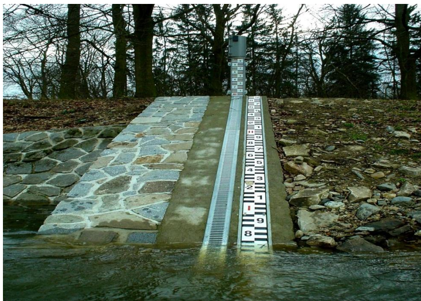
Obrázek č. 7. Hlásný profil „B“ Zadní poříčí. Vodočetná lať, drážka s mřížkou, na jejímž konci se nachází limnigraf. Zdroj: Vlastní výzkum.
