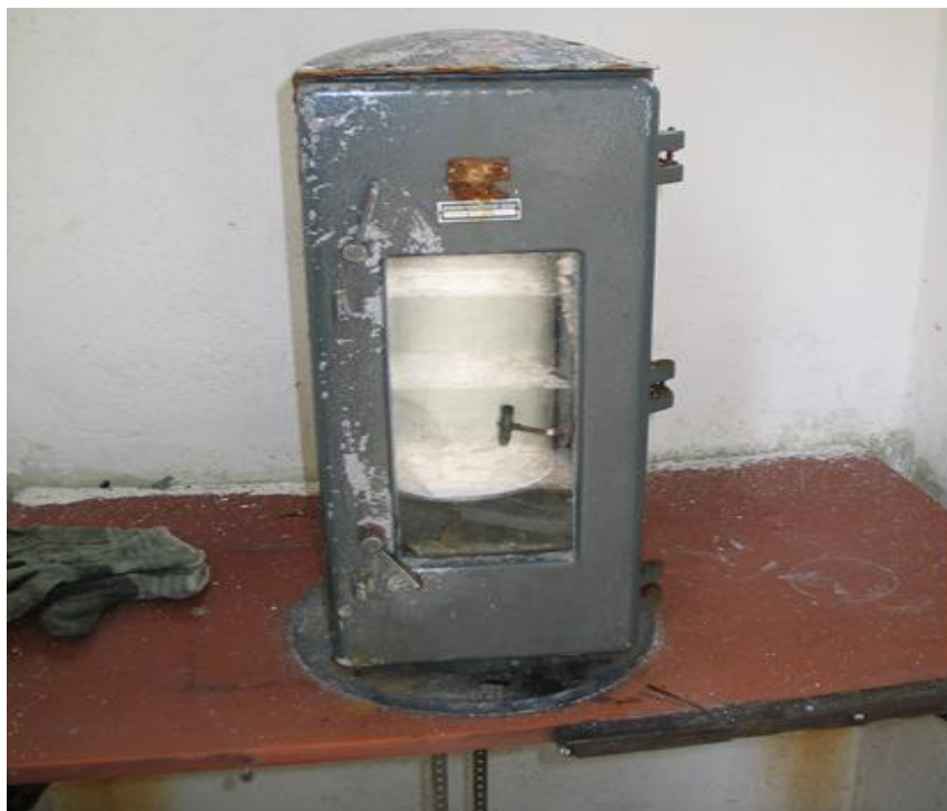
Obrázek č. 4. Klasický limnigrafický přístroje s mechanickým zápisem na limnigrafický papír. Zdroj: Vlastní výzkum.
