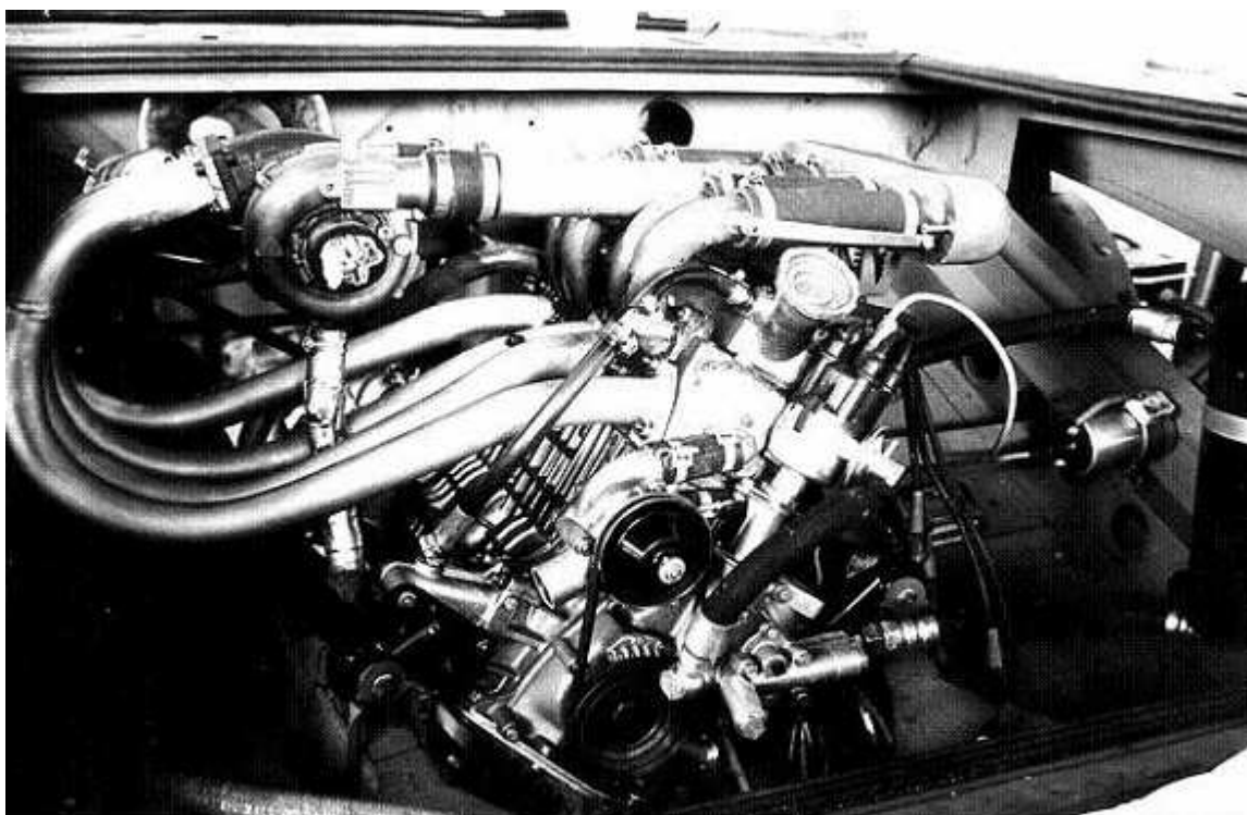
Obr. 5.6 Systém v uspořádání KARBURÁTOR-TURBODMYCHADLO-MOTOR [34]
