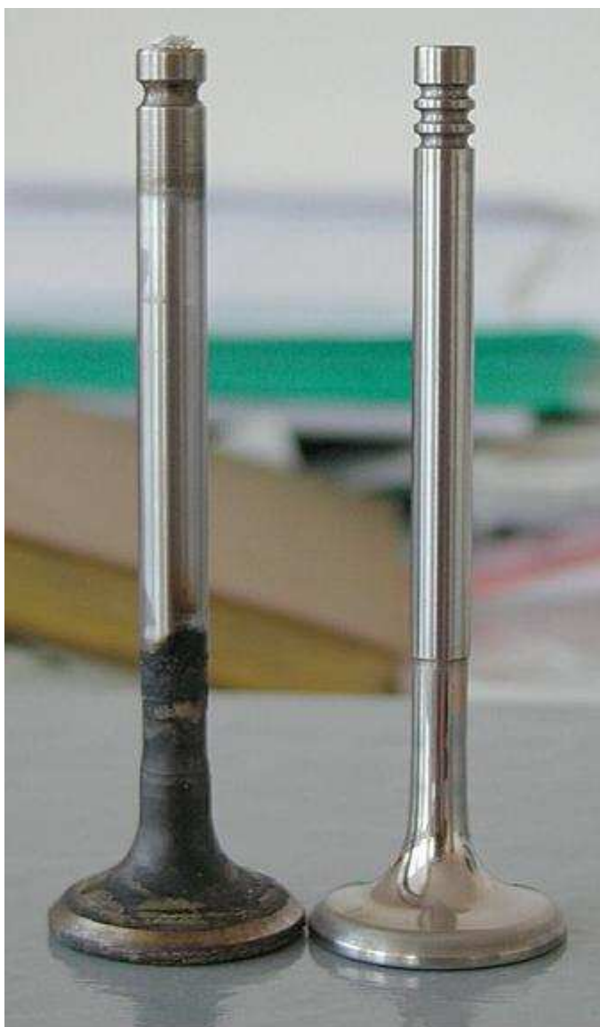
Obr. 4.8 Výfukový ventil Škoda Favorit a vedle upravený ze Škody Felicia [14]
