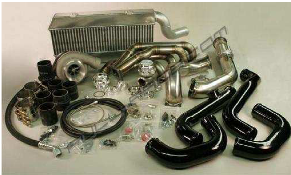
Obr. 5.4 Vše potřebné pro přestavbu na "turbo" [33]
