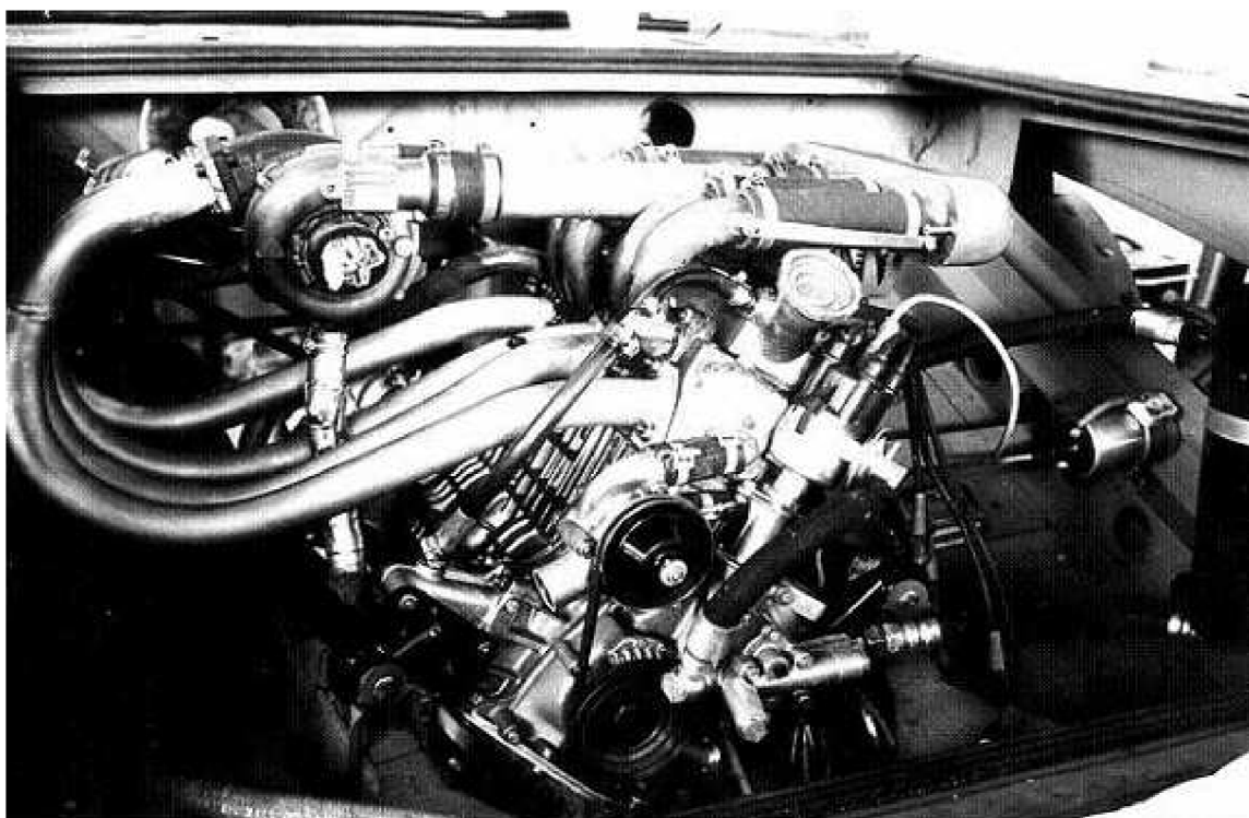
Obr. 5.6 Systém v uspořádání KARBURÁTOR-TURBODMYCHADLO-MOTOR [34]
