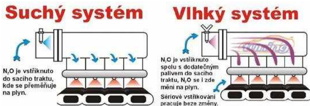
Obr. 6.3 Porovnání systémů vstřikování oxidu dusného [41]
