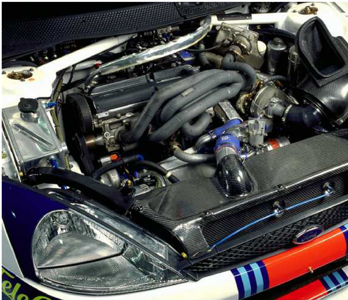
Obr. 5.7 Ford Focus RS WRC má značně složitě výfukové potrubí [35]
