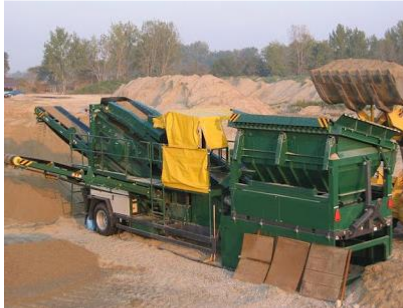
Obrázek 14 - Semi-mobilní drtič na zpracování SDO
