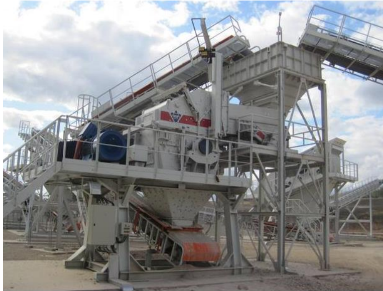
Obrázek 15 - Stacionární souprava na zpracování SDO
