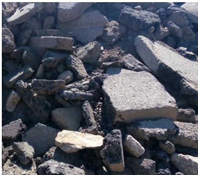
Obrázek 7 - Asfaltový odpad z povrchu vozovky
