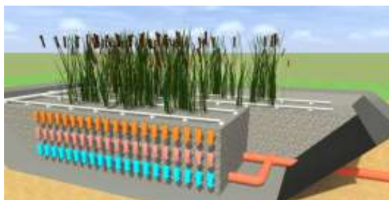
Obrázek č. 6: Model vertikálního filtru KČOV. (Křiška, 2015).
