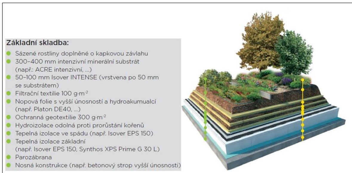
Obr. č. 1- Skladba intenzívnej vegetačnej strešnej konštrukcie [17]
