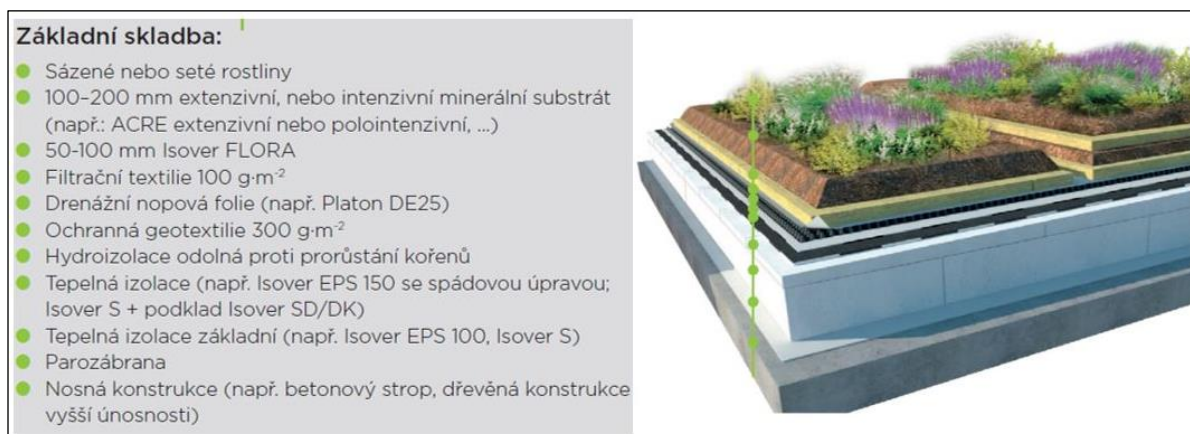
Obr. č. 2- Skladba extenzívnej vegetačnej strešnej konštrukcie [17]
