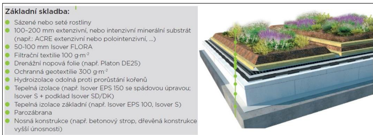
Obr. č. 2- Skladba extenzívnej vegetačnej strešnej konštrukcie [17]
