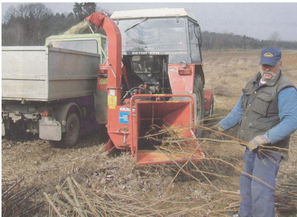
Obrázek 5: Dvojfázová sklizeň pokusné výmladkové plantáže v ČR (Havlíčková K. a kol., 2005)
