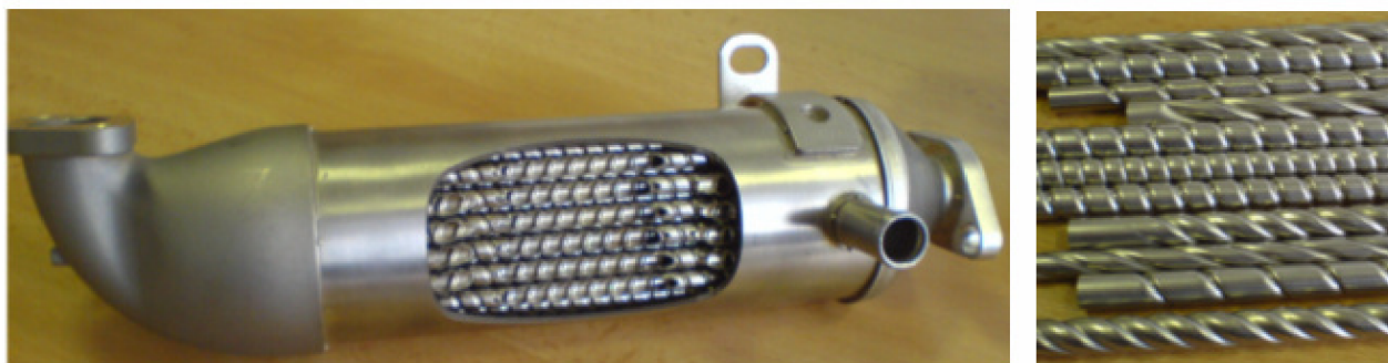
Obr. 44: EGR výměník v částečném řezu (vlevo) a různé druhy trubiček pro výměníky se spirálovou drážkou (vpravo)
