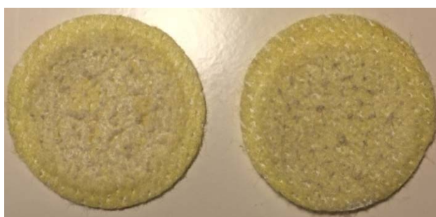
Obrázek 28: Výsledky zkoušky na oděr laminát č. 2
