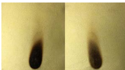
Obrázek 26: Výsledky zkoušky hořlavosti laminát č. 2
