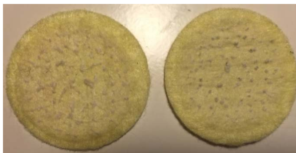
Obrázek 27: Výsledky zkoušky na oděr laminát č. 1
