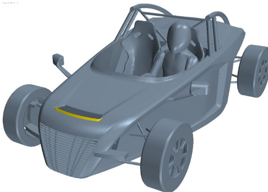
Obr. 38 Varianta 4 vznikla přidáním náběžné hrany k variantě 1.
