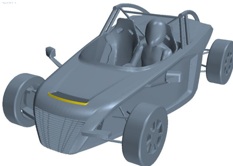
Obr. 38 Varianta 4 vznikla přidáním náběžné hrany k variantě 1.
