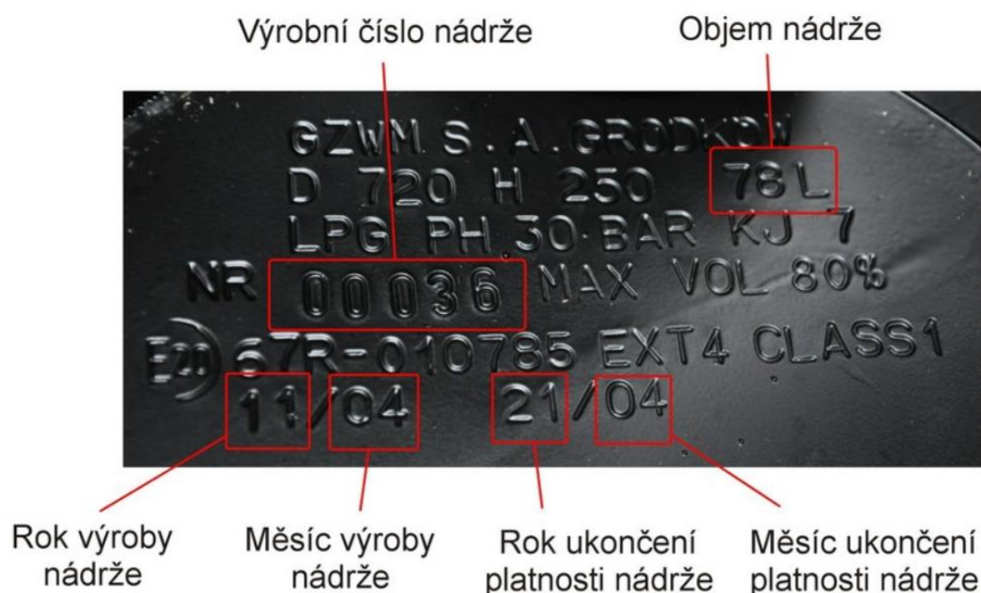
Obrázek 1.7 - Identifikační štítek LPG nádrže od výrobce GZWM, (lpg-autogascentrum.cz, 2023)
