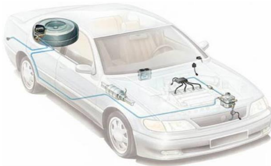
Obrázek 1.5 - Systém LPG se sekvenčním vstřikováním, (autanaplyn.cz, 2023)
