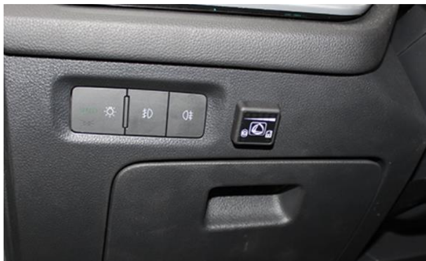
Obrázek 1.14 - Přepínač benzín/plyn nainstalovaný ve voze Škoda Octavia (lpg-agcplus.cz, 2023)
