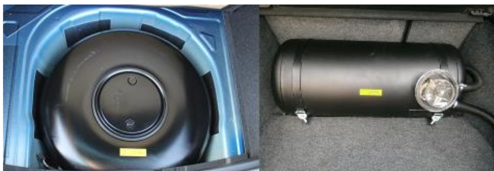
Obrázek 1.2 - Plynová nádrž toroidní (vlevo) a válcová (vpravo), (agcplus.cz, 2022)
