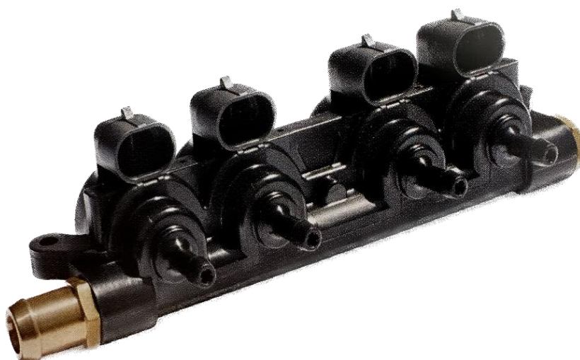
Obrázek 1.13 - Vstřikovací lišta EVO-A značky Landi Renzo (Firemní materiál Landi Renzo, 2023)
