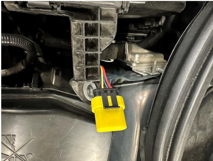
Obrázek 4.2 - Diagnostická zásuvka s ochrannou krytkou
