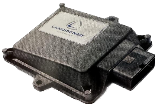
Obrázek 1.12 - Řídící jednotkaš EVO značky Landi Renzo (Firemní materiál Landi Renzo, 2023)
