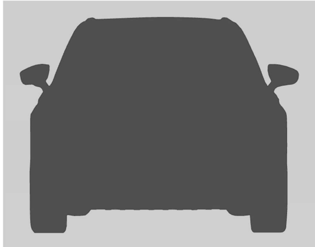
Obr. 35 Určení čelní plochy experimentálního vozidla v softwaru Inventor
