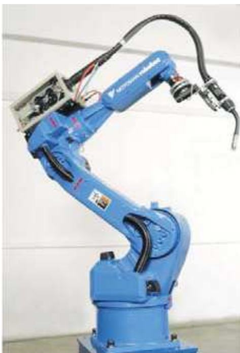
Obr. 9 Klasický univerzální robot s vedením kabeláže svařovacího hořáku vně horního ramene robota. [5]
