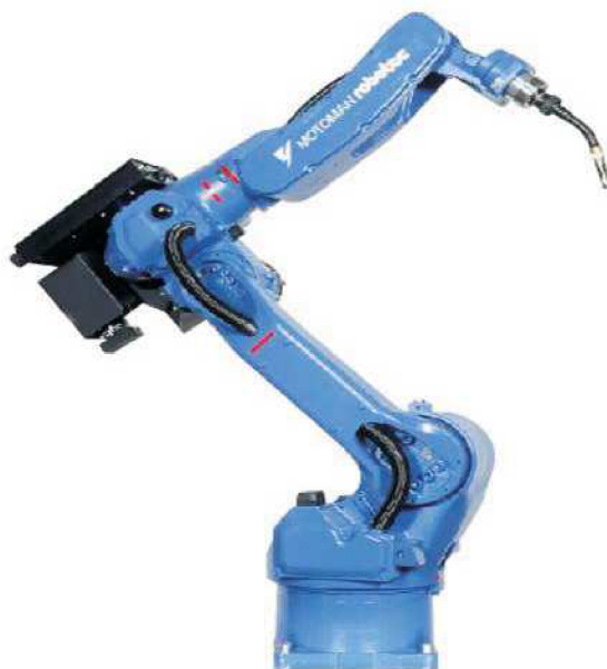
Obr. 10 Svařovací robot s vedením kabeláže svařovacího hořáku uvnitř horního ramene robota. [5]
