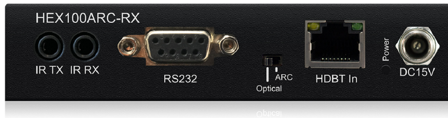
Obr. 2.2: Na obrázku je jedna zo strán HEX100ARC-RX prijímača. Je možné vidieť RS-232, IR vstup/výstup, vstup HDBaseT RJ45 a napájanie 4 .
