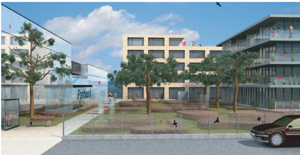
Obr. 14: Koncepce návrhu výstavby bytových domů s důrazem na použití moderních materiálů (sklo, beton a železo). Čísly jsou označeny rizikové plochy a faktory zvyšující rizikovost staveb. Místa s čísly 1, 5, 6, 7, 9, 10, 12, 13 jsou riziková pro svou průhlednost. Místa s čísly 2, 8, 9 jsou vysoce reflexivní a místa s čísly 3 a 4 jsou místa, kde je nevhodně naplánovaná zeleň. (Převzato a upraveno ze Schmid et al. 2013.)
