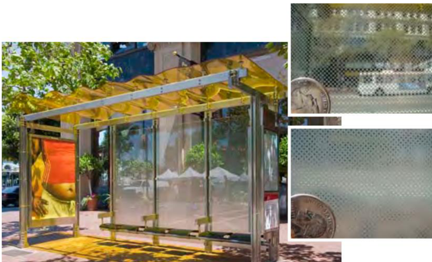
Obr. 19: Design zvaný „SF Fog“. Jak je vidět z detailu vpravo, hustota teček se postupně od spodu k vrchní části skleněné plochy snižuje, čímž imituje mlhu. Hustota a velikost teček je porovnána s americkou čtvrtdolarovou mincí (detailní obrázky). (Převzato a upraveno z Rodgers a Sheppard 2010).
