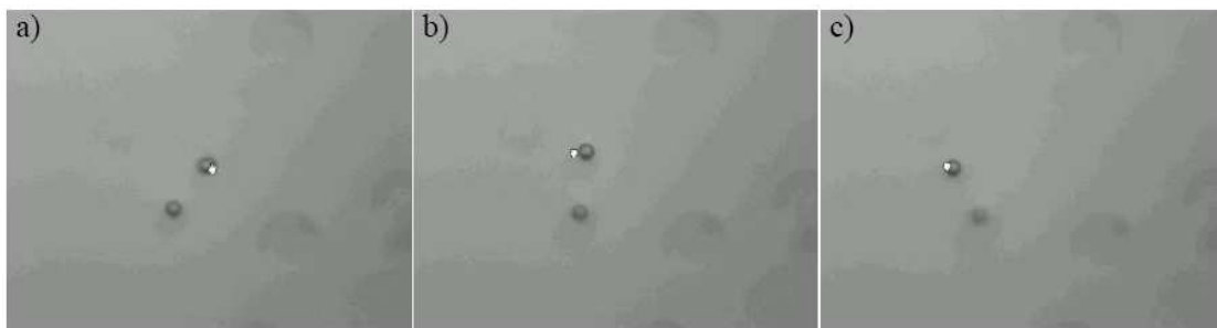
Obrázek 31: Prostorová manipulace s polystyrénovou kuličkou o průměru 3 \mu\text{m} .
