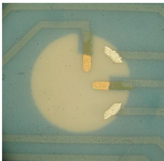
Obr. 8.4: Detail stavu vodivých cest před natištěním elektrod.
